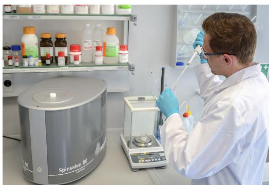
図 1.製品の迅速な分析のために化学実験室で使用される Spinsolve NMR 分光計
