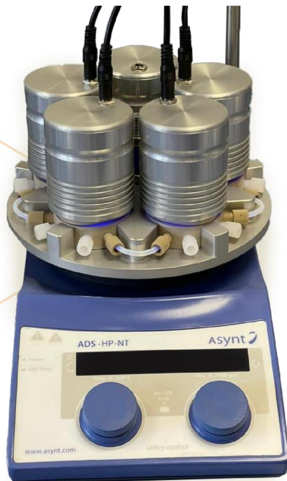
加熱と攪拌は上図 マグネット式ホットプレートスターラーを使用
