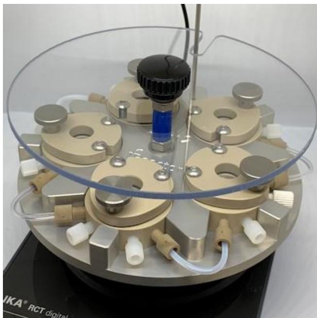
fReactorは、操作がフレキシブルでとても使い勝手が良いです。別々の反応ゾーンを形成する5つのモジュールが良好な滞留時間分布を提供します。5つのモジュールは、一般的な実験用ホットスター-ラー上の金属製のベースプレートに置きます。そして、それぞれのゾーンを混合すれば、この容器は単相・多相反応のどちらの場合も滞留時間の長さに大きな柔軟性をもたらします。複数のポートにより反応のフレキシビリティ、サンプリングまたは反応器内のセンサーの統合を可能にします。
